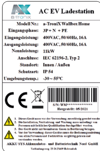
Abb. 4-3 Typenschild der Ladestation
